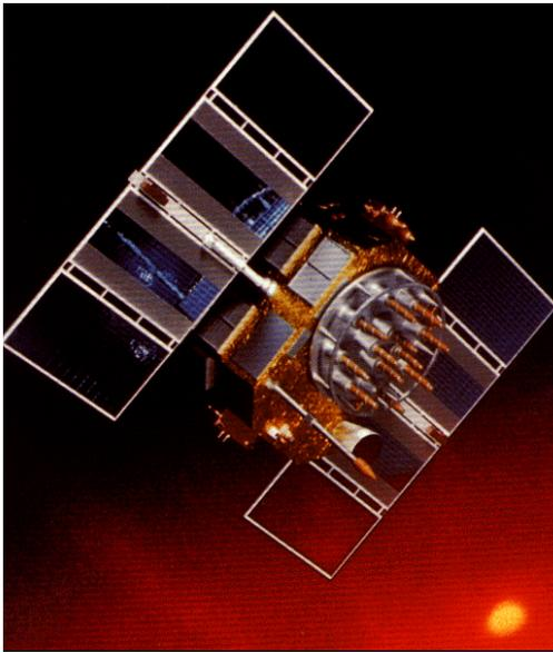
**Fig. 14-1. Block II GPS Satellite**
