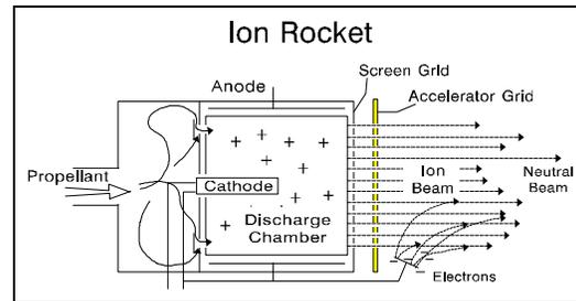
**Fig. 5-6. Ion Acceleration**
