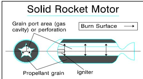
**Fig. 5-9. Solid Propellant Motor**
