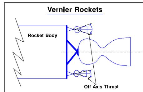
**Fig. 5-14. Vernier Rocket**
